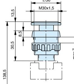
**Pushbutton – Type: 13T-RF-22, 13T-RF-30**
