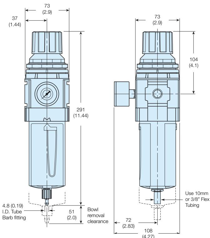
**Manual Drain****Automatic Drain**
