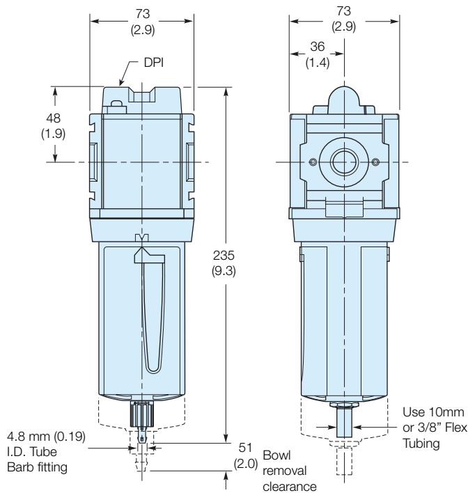
**Manual Drain****Automatic Drain**
